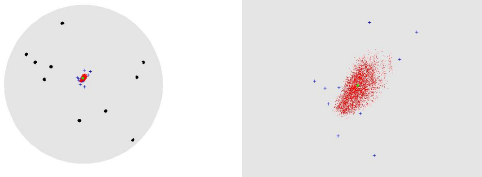
FIGURE 4.2 – Calculs de centres sur la sphère. En noir : 10 points tirés aléatoirement sur la sphère. En bleu : points obtenus par tir géodésique depuis chacun des points dans la direction du gradient de la fonctionnelle minimisée par la moyenne de Fréchet. En rouge : centroïdes obtenus par le procédé de barycentre itéré (4.7) avec différents ordres des points. En vert : moyenne de Fréchet des 10 points. Tous ces centres seraient confondus dans le cas d’une géométrie euclidienne.
