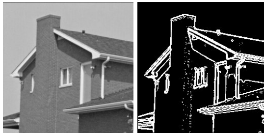
FIG. 4.6 – Image originale en niveaux de gris (à gauche) et image binaire de contours calculée par l’opérateur de Sobel (à droite).
