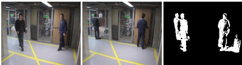
FIG. 3.1 – Séparation du fond et des objets par comparaison avec une image de référence : image analysée (à gauche), image de référence (au centre), et résultat (à droite).
