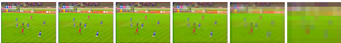
FIG. 7.3 – Représentation d'une image à différentes résolutions, depuis r = 0 (gauche) jusqu'à r = 5 (droite). Les images ont été rééchantillonnées pour observer les différences de détail.
