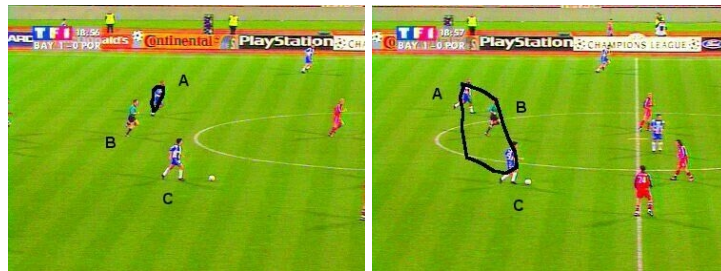
FIG. 7.1 – Incapacité du snake à gérer des objets proches ou un arrière-plan contenant des pixels de fort gradient. Le suivi d'objet peut être correct à un instant donné (à gauche) mais échouer après des phénomènes d'occlusion, le joueur B passant ici devant le joueur A (à droite).
