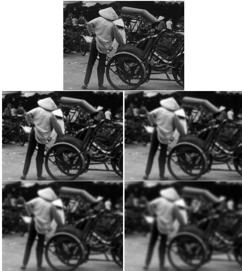
FIG. 8.1 – Application de l'équation de la chaleur. De haut en bas et de gauche à droite : image originale u_0 ; images auxquelles a été appliquée l'équation (8.1), respectivement pour des temps t = 1, 3, 5, 10 . On remarque en particulier que les détails disparaissent et que les images deviennent floues lorsque t augmente.
