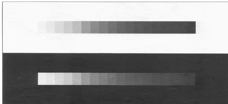
FIG. 1.2 – La perception des différentes gradations d'une échelle de gris dépend du niveau lumineux du fond.
