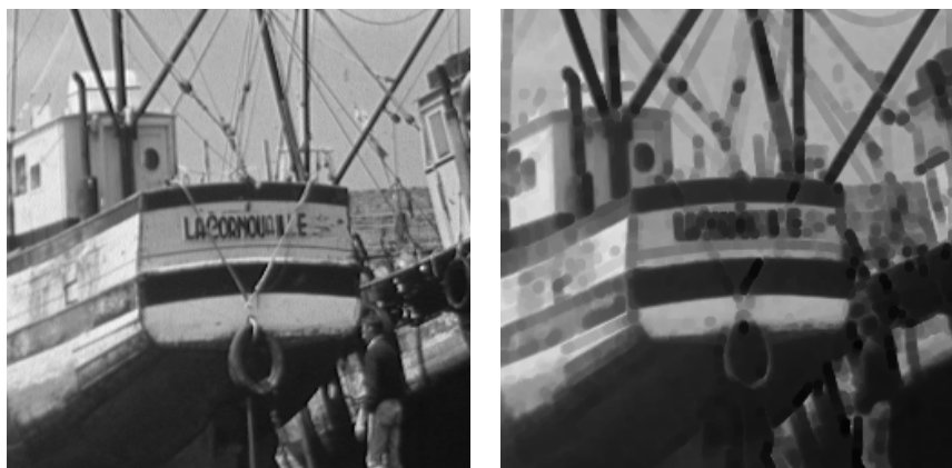
FIG. 6.5 – Exemple d'érosion numérique (de gauche à droite : image initiale et érosion par un disque de taille 3).
