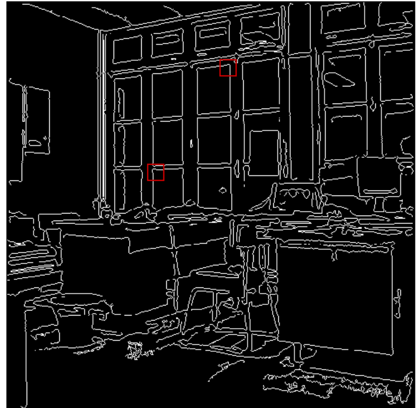
Passage par zéro du Laplacien et seuillage par hystérésis
