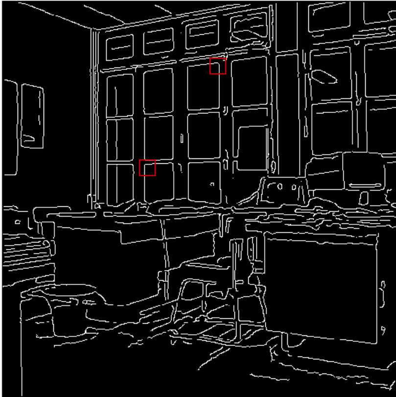
Maxima du gradient et seuillage par hystérésis
