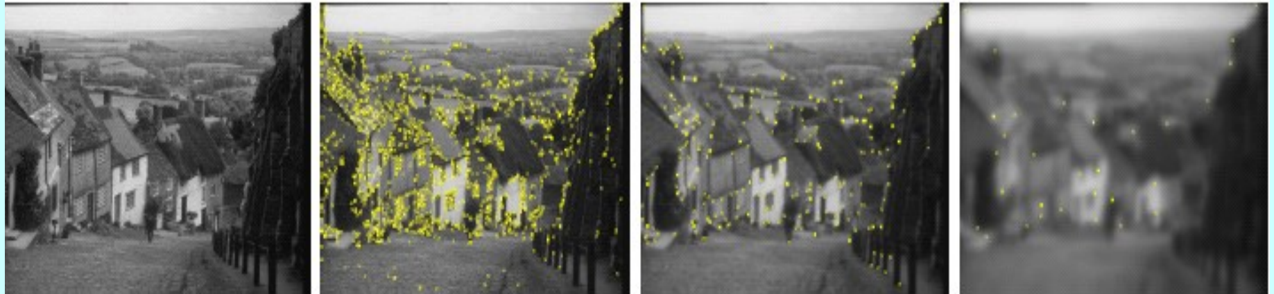
Détection de points d'intérêt (ou points anguleux)
