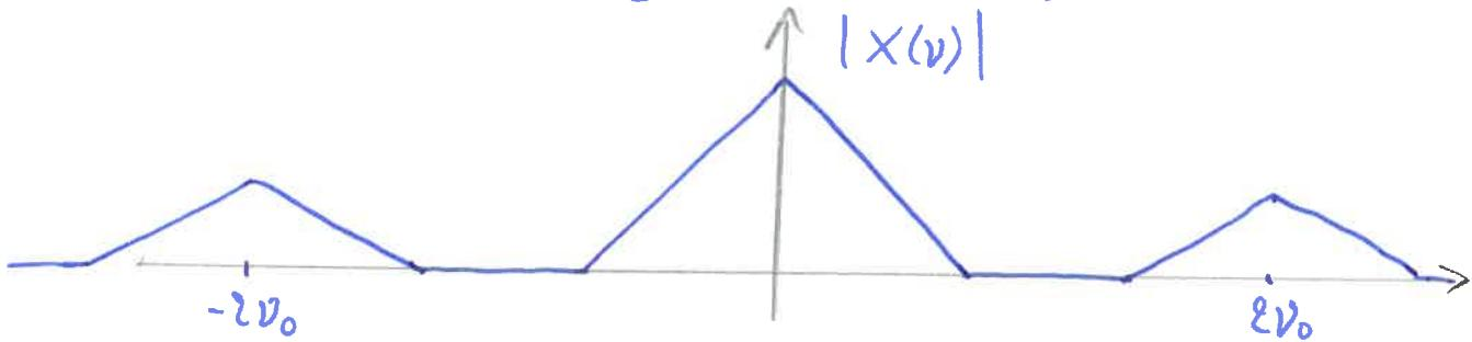
0.5 Pour récupérer  $m$  à partir de  $x$ , il suffit donc de faire un filtrage passe-bas de  $x$ , de manière à ne garder que la partie centrale (passe-fréquence) du son spectre.
